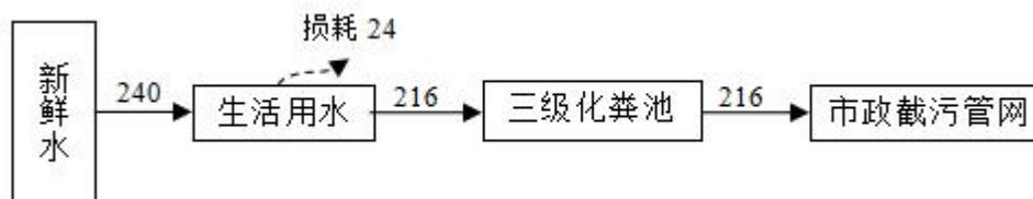
图 3-4 建设项目水平衡图（单位： $\text{m}^3/\text{a}$ ）
